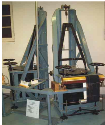
Dieser alte Seismograph zur Erdbebenaufzeichnung steht im Taunusobservatorium auf dem Kleinen Feldberg. Schon seit über 100 Jahren werden Erdbeben aufgezeichnet.
