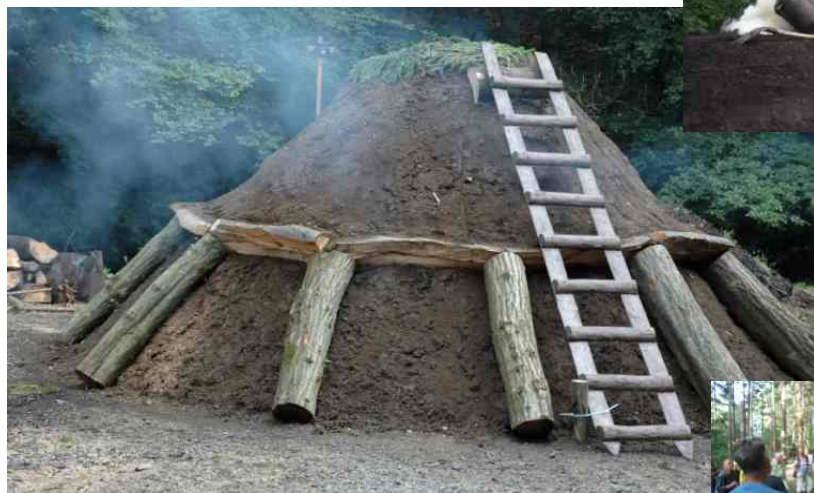
Ein gerade in Betrieb genommener Kohlenmeiler. Die Holz-scheite dienen zur Stabilisierung der äußeren Erdschicht.
