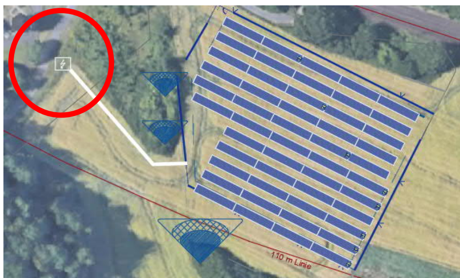
Geplanter Übergabepunkt (Trafostation) an das Mittelspannungsnetz
